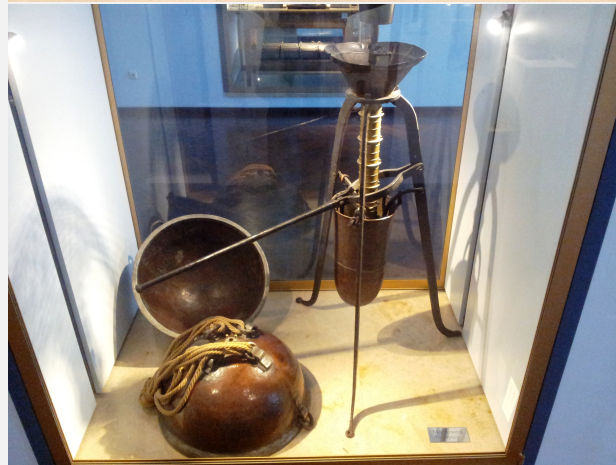
Boven: Een prent van het experiment van Gaspar Schott uit 1672. Bron: http://en.wikipedia.org/wiki/Magdeburg_hemispheres Onder: De originele Magdeburger bollen met pomp in het Deutsches Museum in München. Foto: Karel Kok, 2014.
